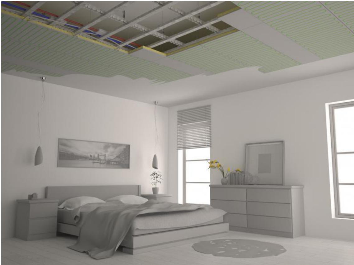
Figura 50 - Pannelli radianti a soffitto
